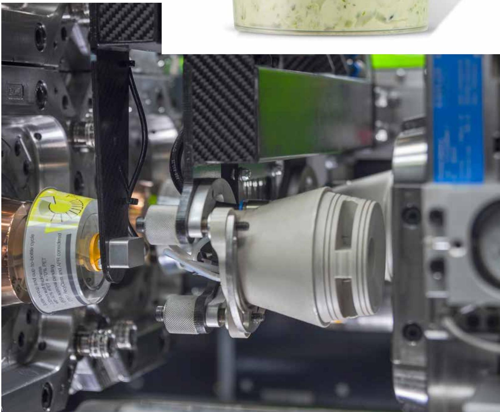
Insieme alla tecnologia IML è possibile produrre in un'unica fase di lavoro packaging a parete sottile in rPET pronto per il riempimento mediante stampaggio a iniezione. (Immagine: ENGEL)
