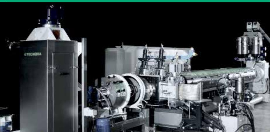
Impianto di rigenerazione mod. E180/54D doppio degasaggio produzione fino a 2000 kg/h
