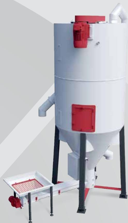
Progettiamo, costruiamo ed installiamo MISCELATORI industriali verticali, SILOS, TRASPORTATORI A COCLEA e VIBROVAGLI per stoccaggio e trattamento di materiali in polvere e granulato.
