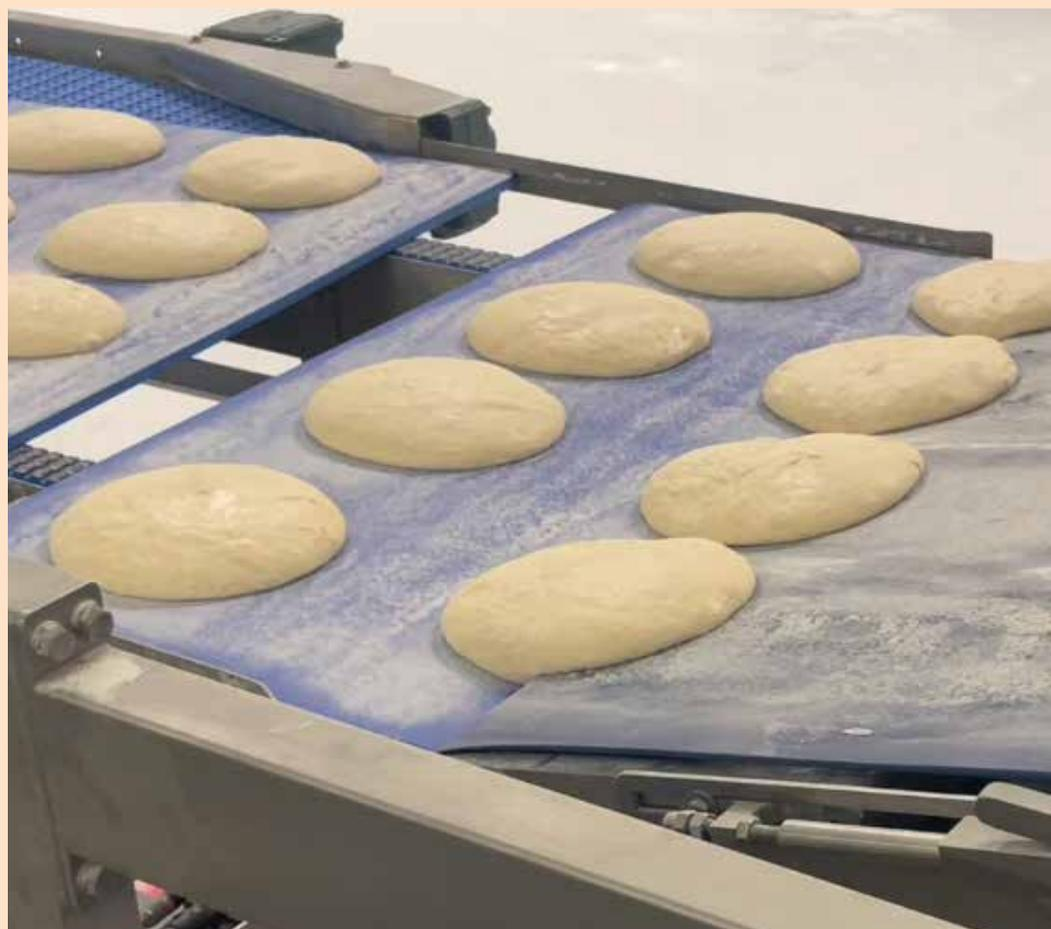
dato molte soddisfazioni. Grazie all'immissione nella Gdo di nuovi prodotti da forno, come ad esempio la Pinsa Romana, AM Technology ha avuto la possibilità di farsi conoscere con il sistema "Nuvola". Si tratta di un impianto appositamente progettato per la lievitazione di impasti delicati ad alto contenuto d'acqua, come la Pinsa Romana per l'appunto. Molte aziende del settore si sono rivolte a noi per automatizzare la loro produzione e la fetta del merca-
