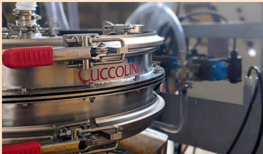
liquidi, dal siero di latte al recupero di acque di lavaggio o di lavorazione. Un altro dei nostri cavalli di battaglia storici è la pasta di nocciola. Attraverso impiantisti specializzati abbiamo fornito più di 300 macchine che vengono utilizzate per filtrarla dagli ultimi residui di nocciola.
